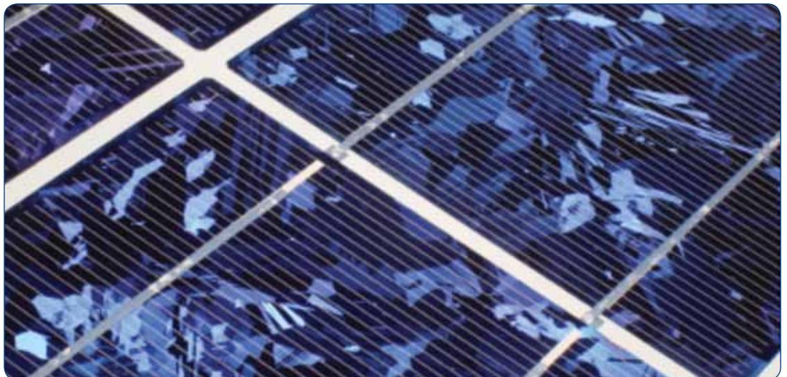
对太阳能光伏电池上的增透膜的厚度和粗糙度的准确测量，对提高它们的效率和可靠性、生产中成本控制起到了关键的作用。连贯相关性干涉技术 (CCI) 给范围广泛的防反射涂层提供了卓越精度的测量方案。
